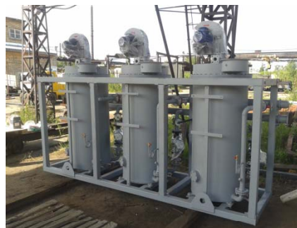
котлоагрегаты, модуль заводской готовности
