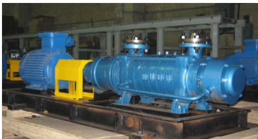
секционный герметичный насосный агрегат для подачи топлива
